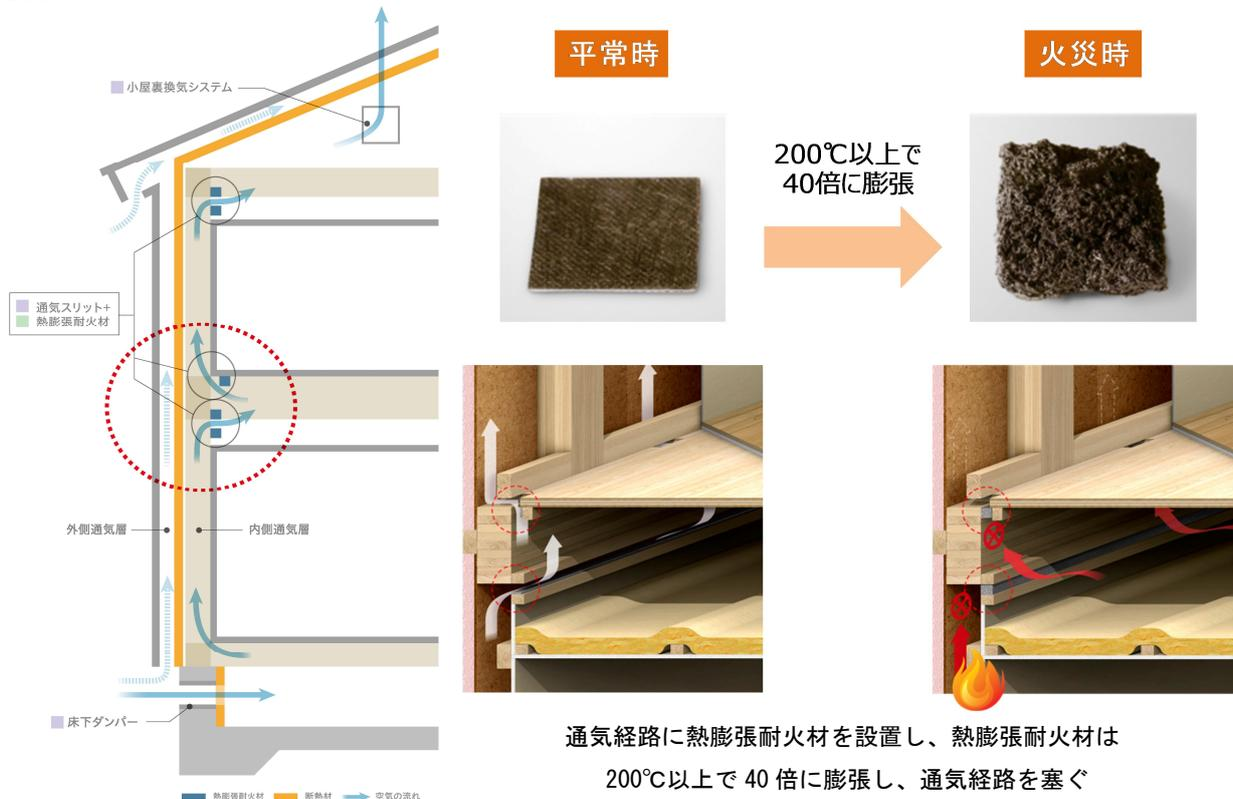
通気経路に熱膨張耐火材を設置し、熱膨張耐火材は200℃以上で40倍に膨張し、通気経路を塞ぐ
